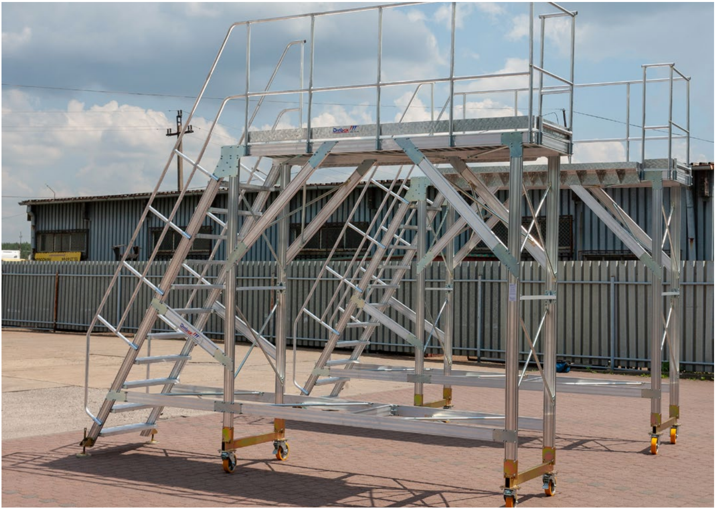
schody lewe i prawe do serwisu pojazdów szynowych, powietrznych, autobusów
